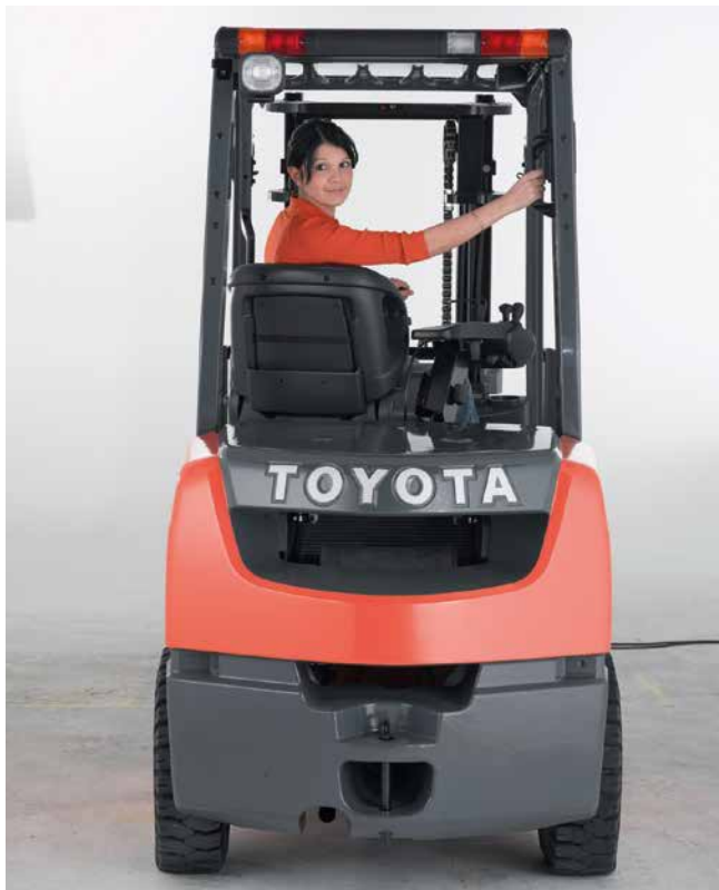
Figur 4: På nogle trucks kan sædet drejes, når man bakker. Det reducerer vrid i ryggen, der er specielt belastende i kombination med vibrationer.
