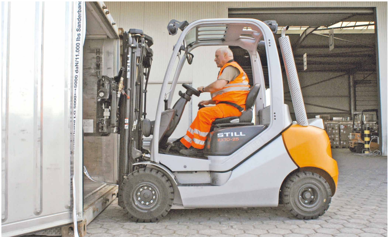
Figur 3: På nogle trucks er førerkabinen elastisk ophængt, hvilket reducerer vibrationsbelastningen.
